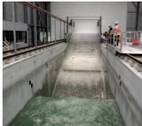
alla creazione di movimenti tipici degli tsunami, passando per la simulazione di mari in tempesta.
